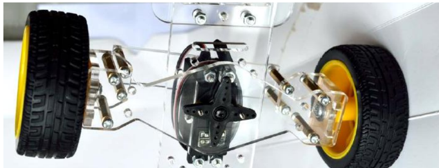
Рисунок 1.15 - Передній привід з використанням крокового двигуна Futaba S3003
